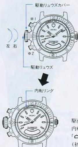
駆動リュウズカバーを回し、止まるまで押し込みロックを解除します。
